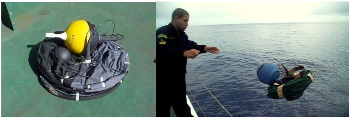
*Boia de deriva pronta para lançamento e sendo lançada posteriormente*
